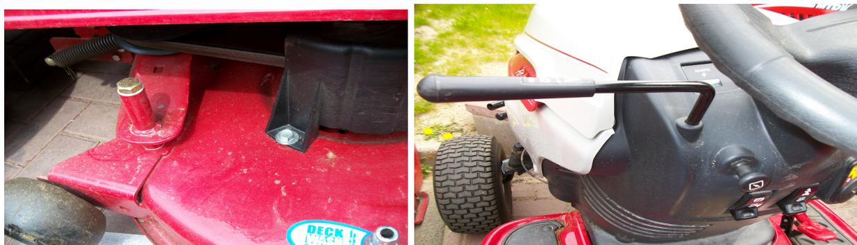
**Der Entspannhebel wird einfach auf den nach oben herausstehenden Zapfen des rechten Spannarms des Mähdecks gesteckt ( Foto 2 u. 3 ) und hinter den Flachstahl des Spannarms geklemmt. Jetzt braucht man nur noch den Entspannhebel nach in Fahrtrichtung rechts ziehen und man kann den Mähwerkskeilriemen leicht demontieren und montieren ( Foto 4 ). Wenn man noch ein passendes Stück Holz zwischen Traktorrahmen und Hebel steckt, hat man sogar noch die Hände frei.**
