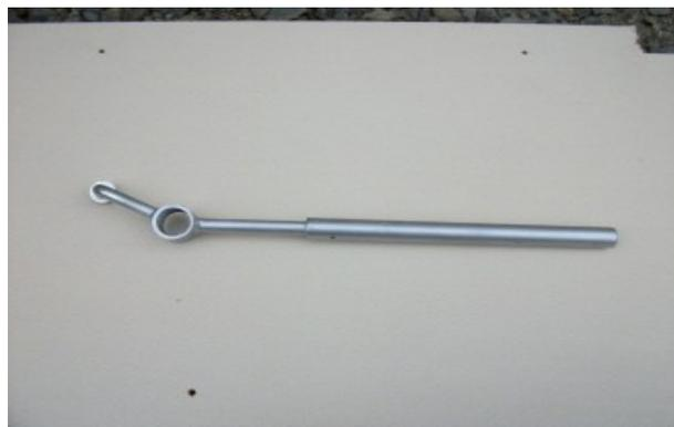
**Der Entspannhebel passt nur bei Modellen mit Messerkupplung, die ihren Betätigungshebel links oben neben dem Lenkrad haben, bei Cup Cadet auch mit Elektrischer Einschaltung ( siehe Foto 1 ) bei Mähdecks mit zwei Messern wo die in Fahrtrichtung links befestigte Spannrolle einen aufwärts weisenden Zapfen( Buchse ) hat Foto 2. Diese Modelle haben alle zwei starke Rückzugsfedern an den Spannrollen beidseitig.**
